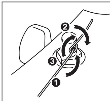
Corte la parte de cuerda sobrante con unos alicates de cortar o una herramienta de corte similar.
